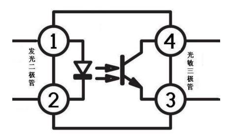
图一 最常用的光电耦合器之内部结构图 三极管接收型 4 脚封装
