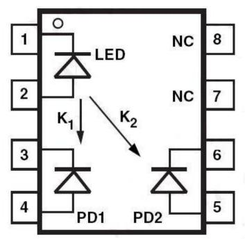
图五 光电耦合器之内部结构图 双二极管接收型 6 脚封装
