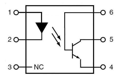
图二 光电耦合器之内部结构图 三极管接收型 6 脚封装
