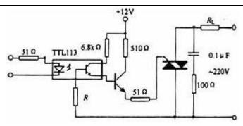
图七 双向可控硅(晶闸管)
