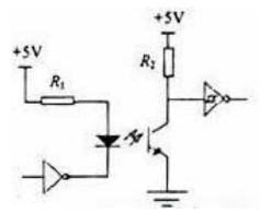
图六 光电耦合器接线原理
