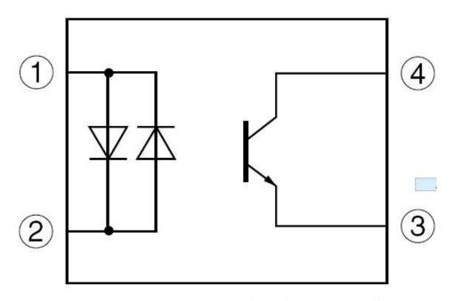
图三 光电耦合器之内部结构图 双发光二极管输入 三极管接收型 4 脚封装
