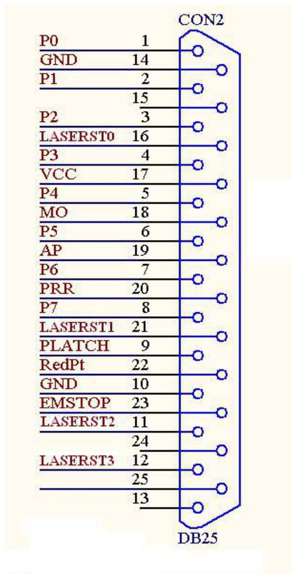
图 2-2 CON2 插座管脚定义示意图
