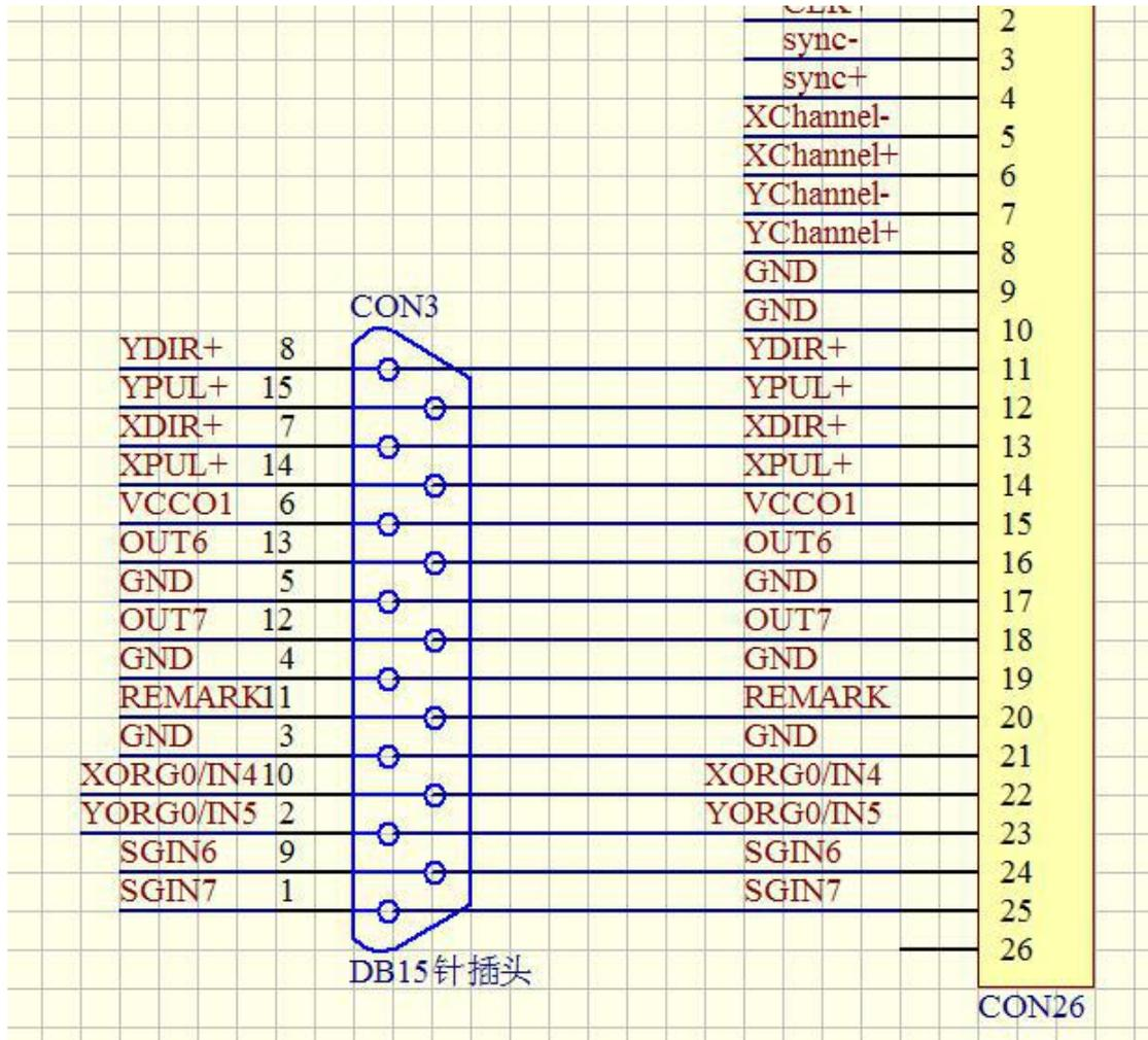
图 2-3 CON3 插座管脚定义示意图
