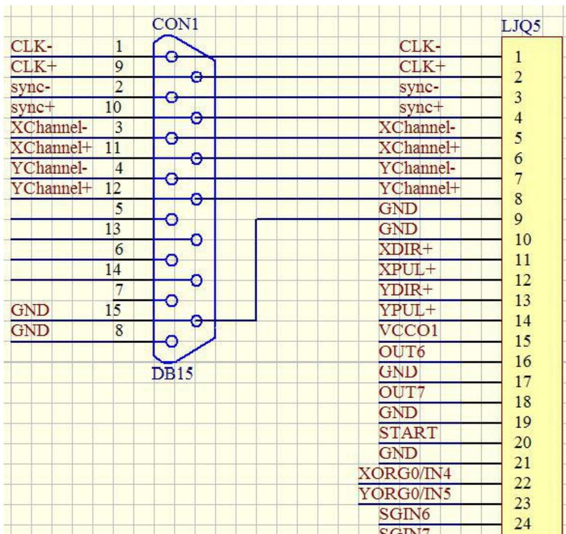
图 2-1 CON1 振镜信号输出示意图
