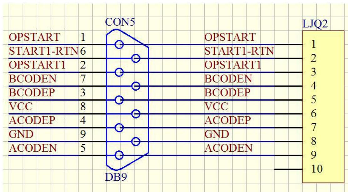
图 2-5 CON5 插座管脚示意图
