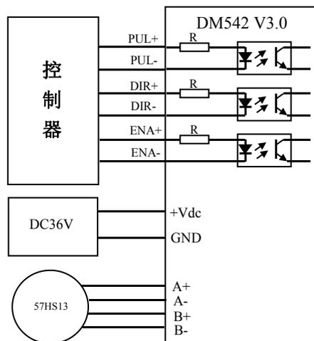
图 6 DM542 V3.0 配 57 电机典型接法
