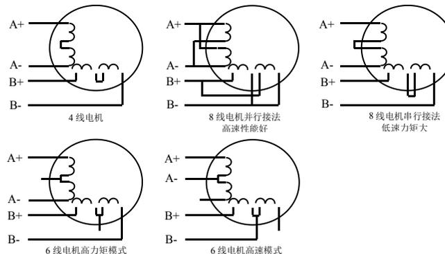
图 5 电机接线图
