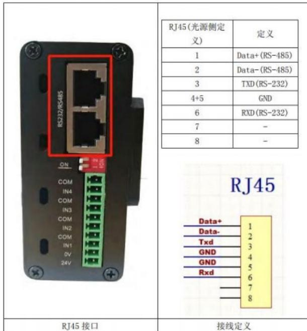
已知 6413 的 485 模式在 COM1 串口上是 1,2 针脚输入输出，需要准备 RJ45 网线将水晶头插入数字光源控制器的 485 RJ45 接口，将另一端的网线拆开，将橙白色的线与 2 连接，黄色的线与 1 连接
